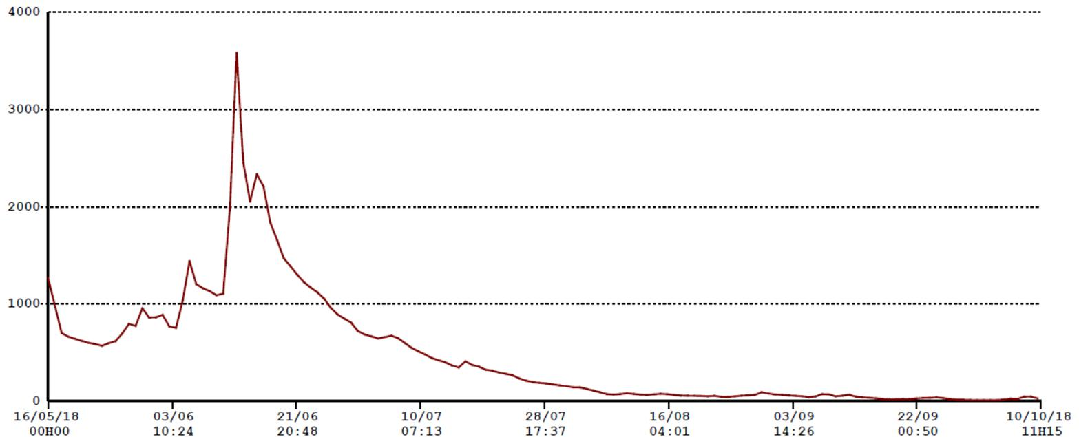
**La station installée courant mai 2018 dispose d'un capteur de mesure hauteur type radar afin d'enregistrer la chronique des hauteurs transformée en débits via une courbe de tarage. Pas de rupture d'écoulement à fin septembre 2018.**
