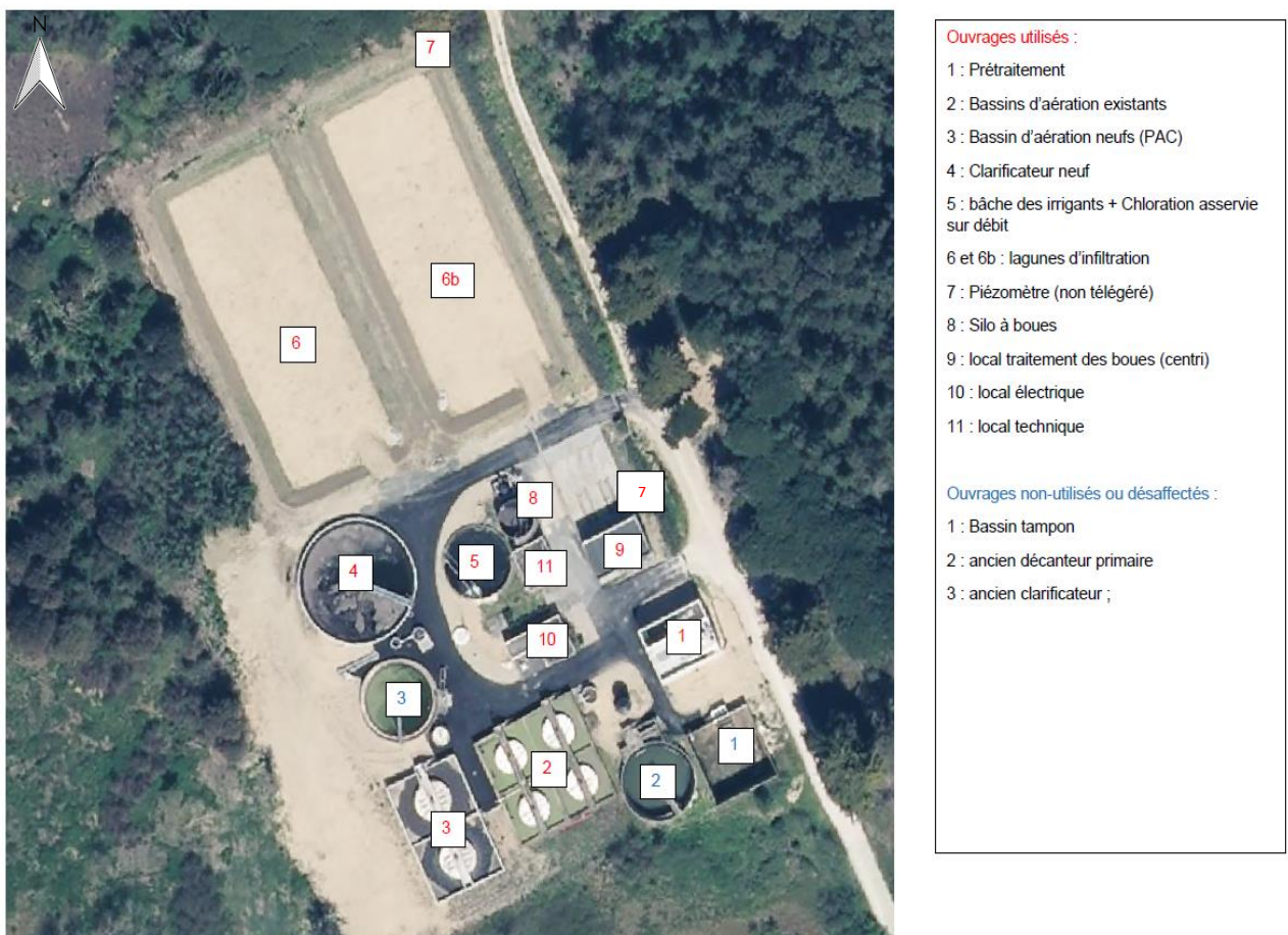
Figure 12 : Ouvrages composant la STEP actuelle – Source : Eau 17
