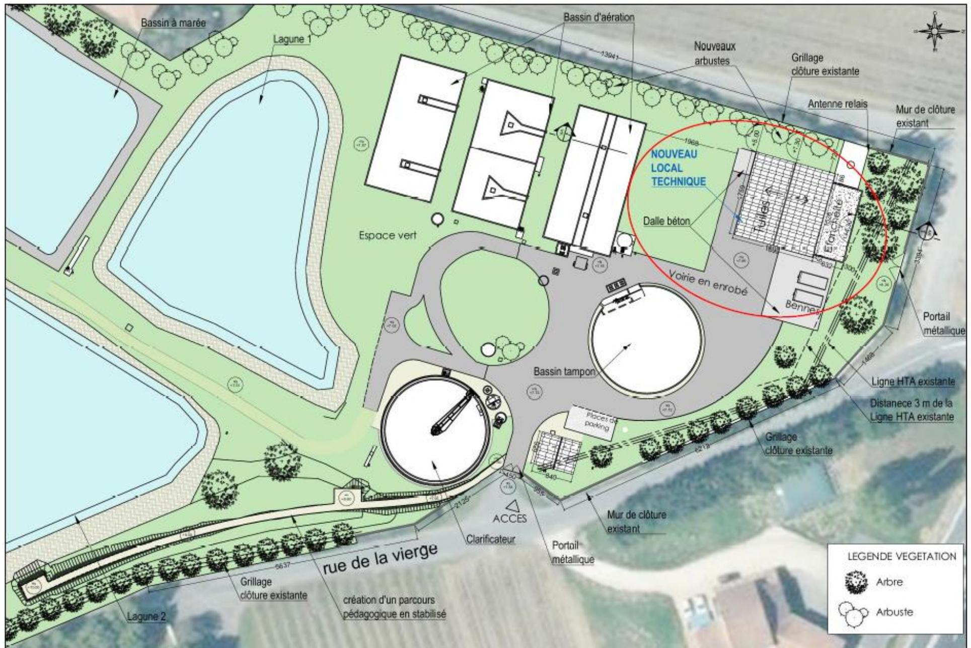
Figure 3 : Plan de masse de la station d'épuration de Sainte-Marie-de-Ré après travaux (Source : dossier PC - OSTINATO)
