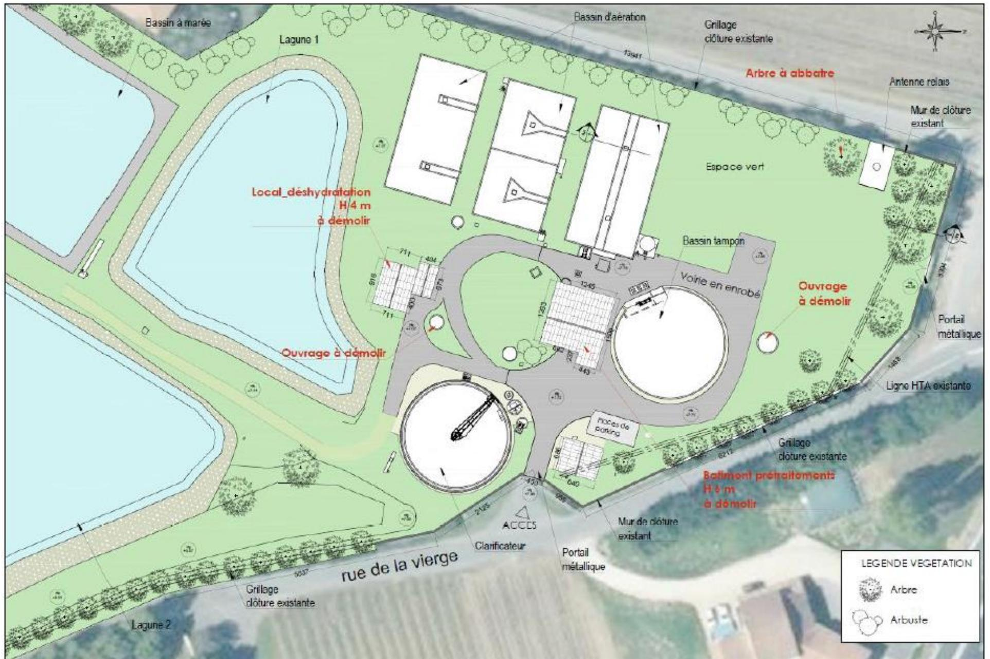
Figure 2 : Plan de masse de la station d'épuration de Sainte-Marie-de-Ré avant travaux - ouvrages à démolir (Source : dossier PC - OSTINATO)
