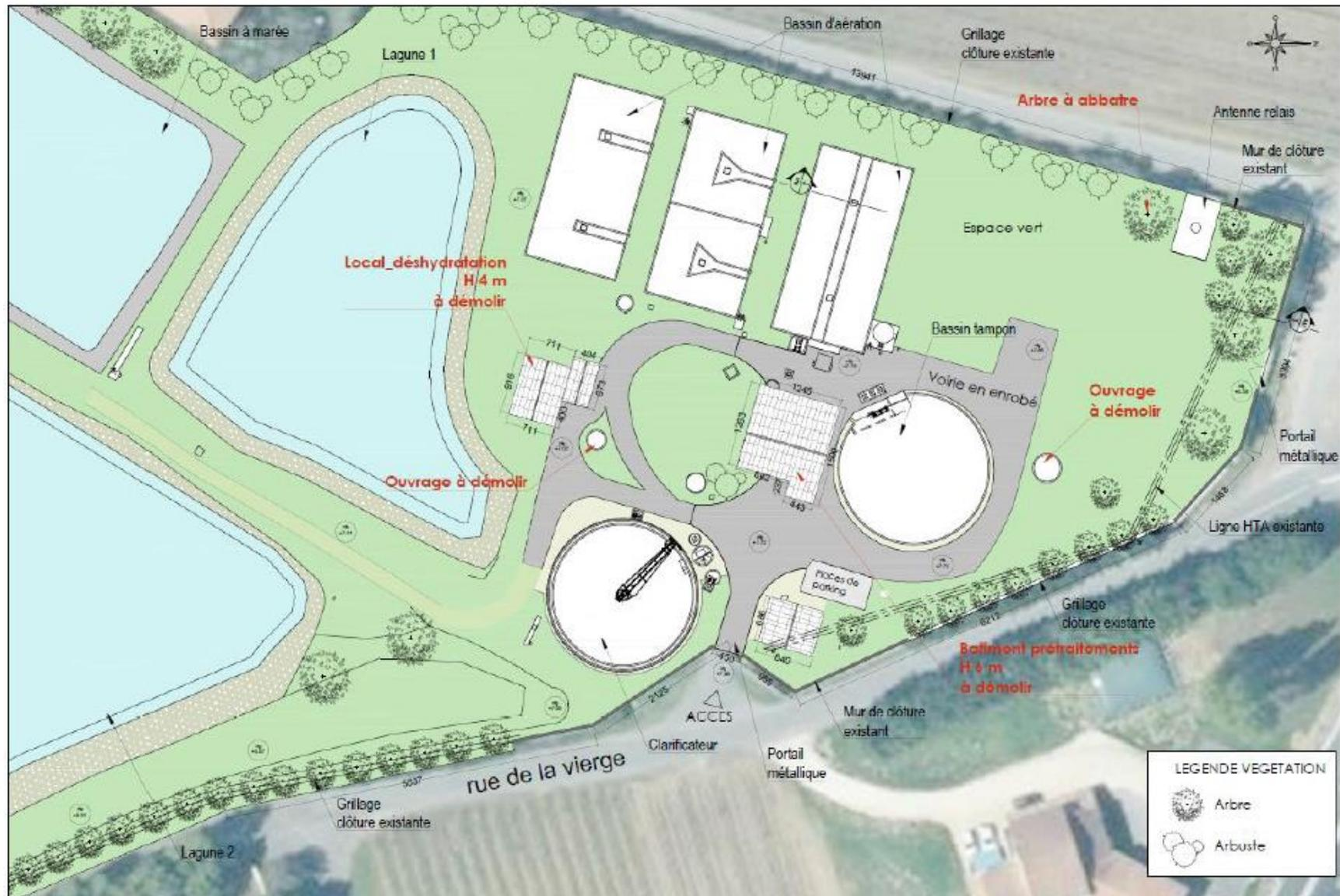
Figure 14 : Plan de masse de la station d'épuration de Sainte-Marie-de-Ré avant travaux (source : Ostinato - Dossier PC)
