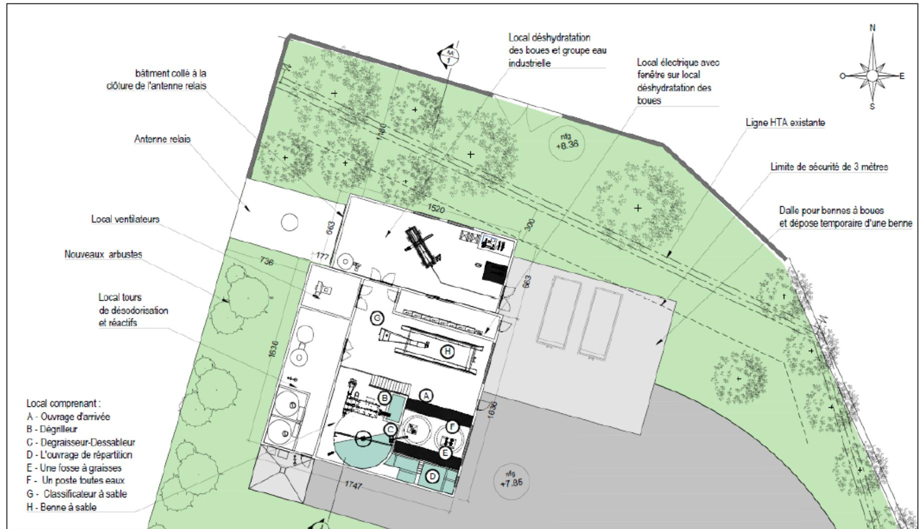
Figure 16 : Plan projet du nouveau bâtiment technique de la station d'épuration de Sainte-Marie-de-Ré (source : *Ostinato - Dossier PC*)
