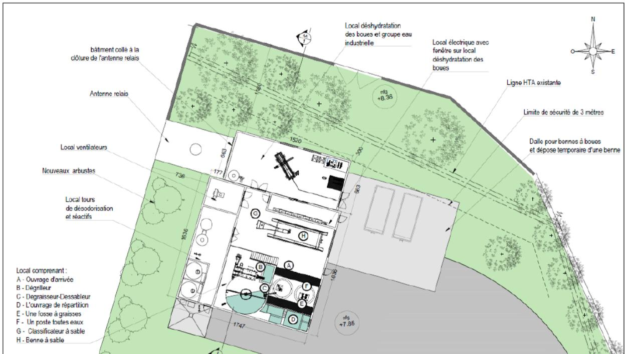
Figure 7 : Plan projet du nouveau bâtiment technique de la station d'épuration de Sainte-Marie-de-Ré (source : Ostinato - Dossier PC)
